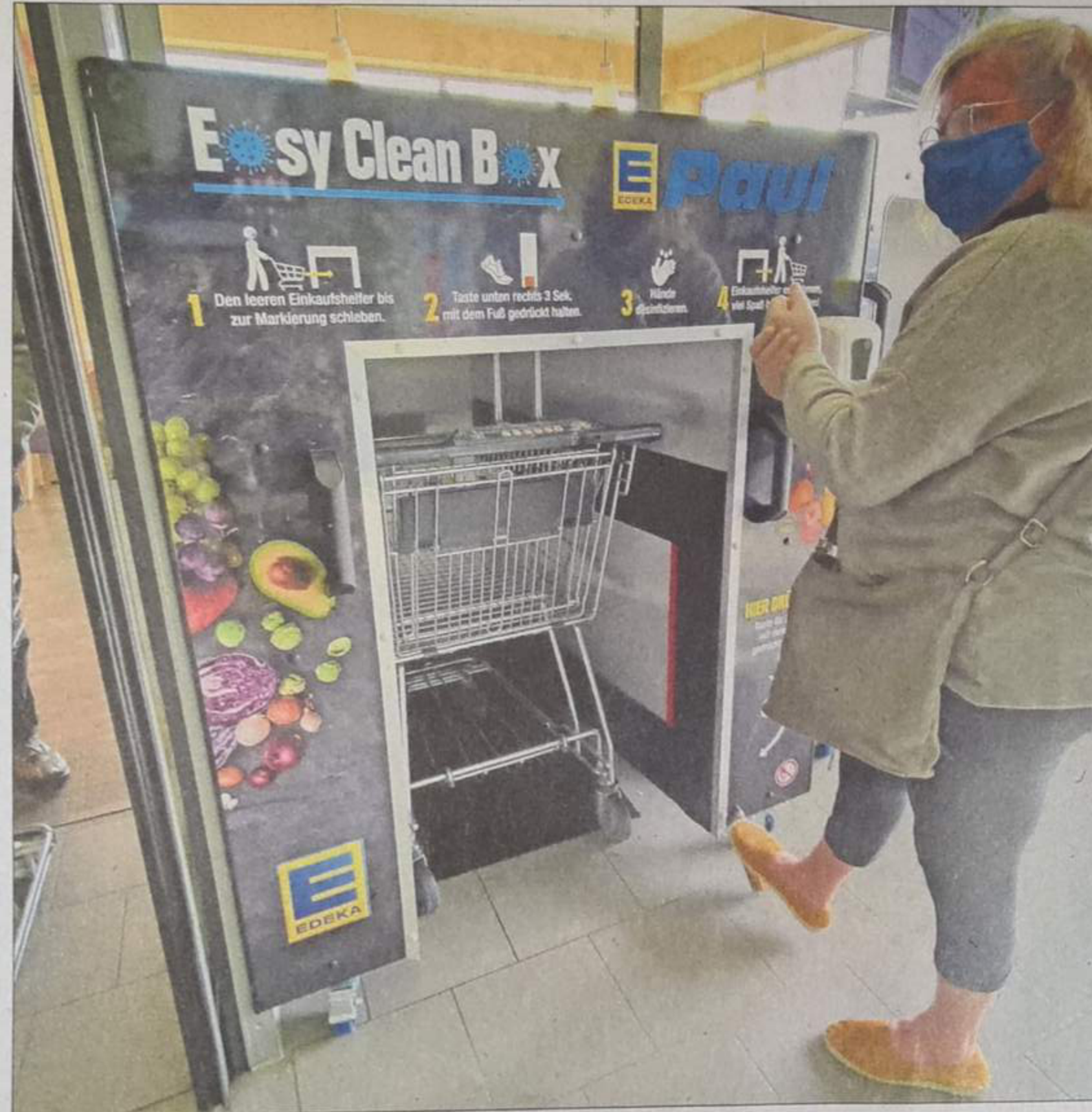
Die „Easy Clean Box“ hüllt den Einkaufswagen in einen Nebel aus Desinfektionsspray.
